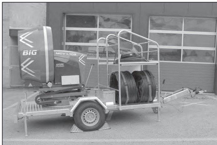
Neubeschaffung mobiler Grosslüfter MGV ( Leistung ca.650'000 m3)
